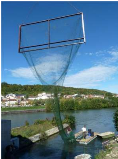
Zdjęcia 7 i 8. Stelaż podtrzymujący siatkę zamontowany za pomocą dźwigu
